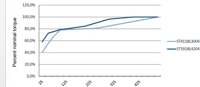
基于无传感器技术的控制不需要使用反电势高的电机，电感越大，电机的动态性能越差。相反，具有低电感，低电阻和高额定电流的电机，拥有更好的工况。
