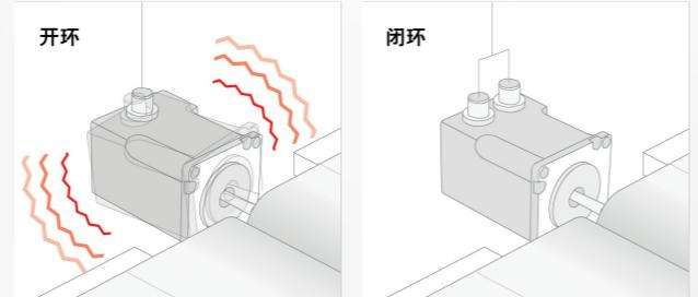
在闭环模式下，控制器根据外部负载需要提供恰当的输出来驱动电机运转，从而有效避免了振动的发生。
